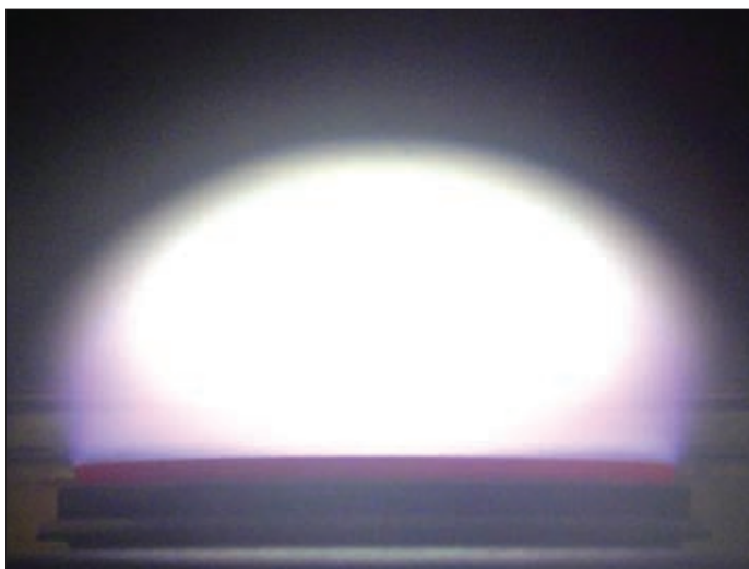
Рис.3. Осаждение алмаза на кремниевую подложку из СВЧ-плазмы
