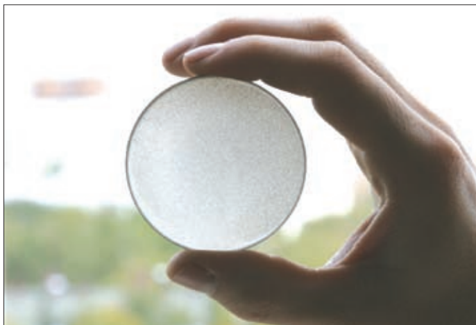
Рис.2. Пластина поликристаллического алмаза (диаметр 57 мм, толщина 0,5 мм)
